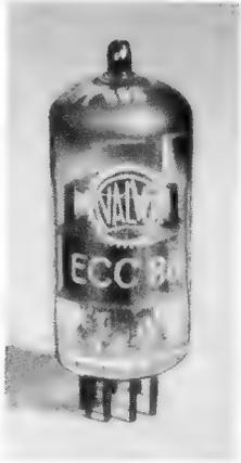
Für die neue Autosuper-Röhre ECC 86 für 6,3 V Anodenspannung bringen wir hier ein vollständig durchgerechnetes und durchgemessenes Schaltungsbeispiel.
