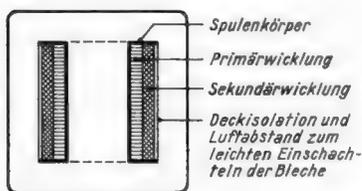
Bild 6. Wickelanordnung beim Dreischenklerkern (M-Kern und EI-Kern)
