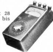
Multiprüfer UO 4 für = u. ~ mit Meßbereichen 0-5 kΩ, 0-12 - 400 V, 0-2 mA mit Meß-schnüren = u. ~ 500 Ω/V
