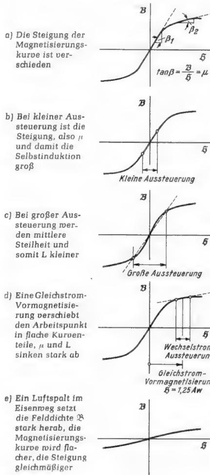
Bild 1. Einfluss von Aussteuerung und Vormagnetisierung auf die Selbstinduktion einer Eisenkernspule
