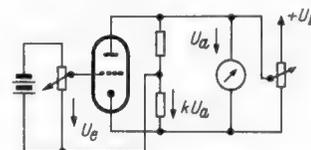
Bild 1. Prinzipschaltung zum Aufnehmen von Ersatzkennlinien für rückgekoppelte Röhren; k = Rückkopplungsfaktor
