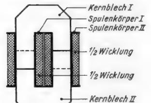
Bild 9. Prinzip des Philberth-Transformators; Zweischlenkelwicklung, verstärkte Joch und innerhalb der Wicklung liegende versetzt angeordnete Stoßfugen setzen die Streuung stark herab
