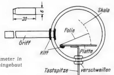
Bild 1. So wird das statische Voltmeter in den Deckel einer Medizinflasche eingebaut
