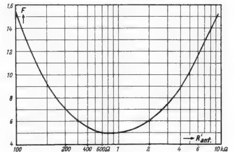
Bild 2. Rauschzahl  $F$  in Abhängigkeit vom Antennenwiderstand  $R'_{ant}$ ; der Optimalwert liegt bei 800  $\Omega$
