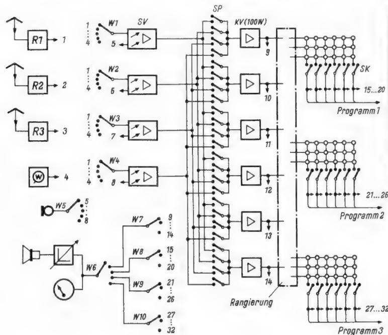
Bild 2. Schaltung einer elektroakustischen Großanlage für Dreiprogrammbetrieb
