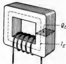
Bild 11. Prinzip der Spule mit Eisenkern. Die Selbstinduktion L hängt vorwiegend von der Länge des mittleren Eisenweges  $l_E$ , des Querschnittes  $Q_E$  und der Windungszahl ab. Form des Eisens und Anordnung der Windungen (verteilt oder konzentriert) beeinflussen die Selbstinduktion nur wenig
