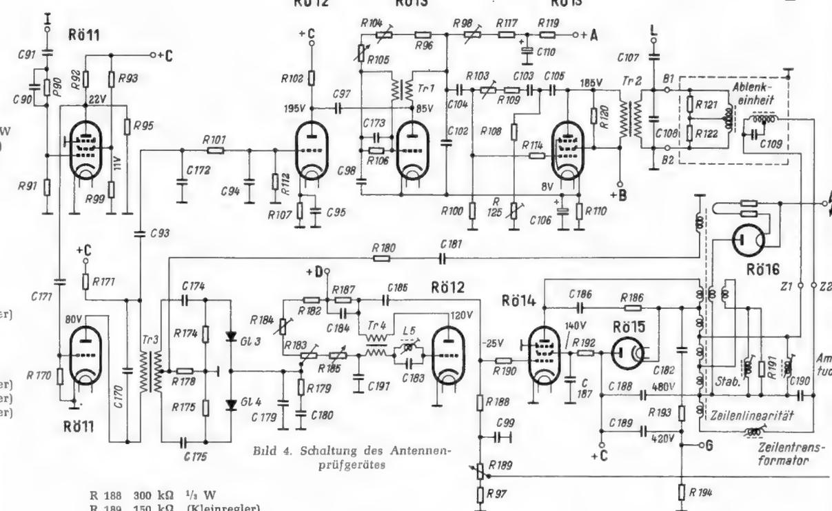
Bild 4. Schaltung des Antennenprüfgerätes
