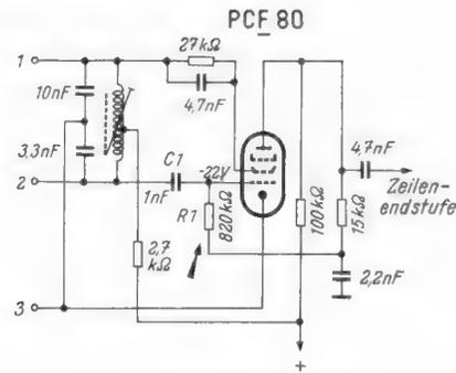
Der Widerstand R 1 am Steuergitter des Pentodensystems der PCF 80 war unterbrochen, dadurch schwang der Zeilenfrequenzgenerator nicht mehr
