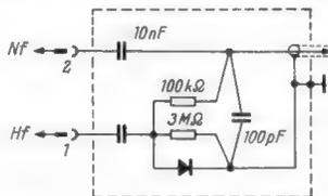
einen kleinen Ankopplungskondensator von 10 pF, der die Kreise wenig belastet und kaum verstimmt, das Hochfrequenzsignal. Das niederfrequente Signal wird der Buchse 2 zugeführt. Über das Abschirmkabel links wird ein Abhörverstärker angeschlossen.
