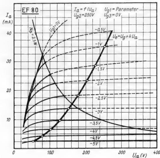
Bild 3. Lage einer Rückkopplungskennlinie  $U_e = U_g + k U_a$  im Kennlinienfeld einer Röhre EF 80
