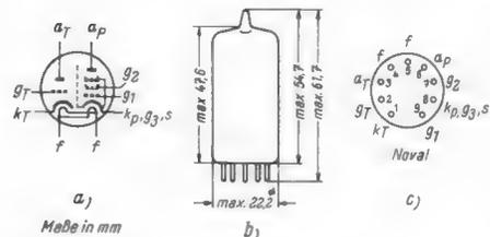
Sockelschaltung a), Abmessungen des Kolbens und der Stifte b) und Stiftbezeichnung c) der Pentode/Triode ECF 83
