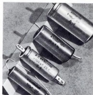
Niedervolt-Elektrolytkondensatoren für Fotoblitzgeräte
