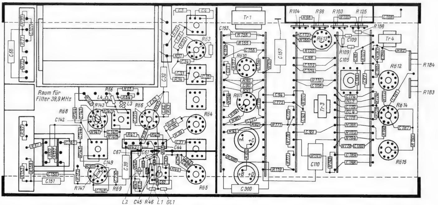
Bild 9. Verdrahtung und Lage der Einzelteile unterhalb des Chassis
