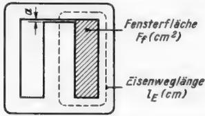
Bild 2. M-Kern; nach DIN 41 302 sind M-Kerne ohne Luftspalt oder mit Luftspalt a von 0,3, 0,5, 1 und 2 mm vorgesehen
