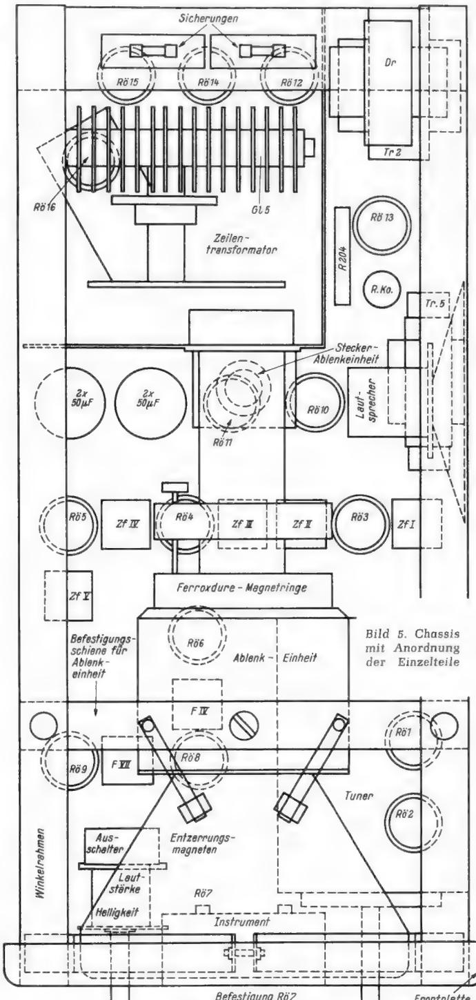
Bild 5. Chassis mit Anordnung der Einzelteile
