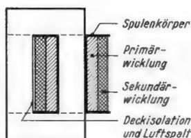
Bild 7. EI-Kern mit Einschlenkelwicklung
