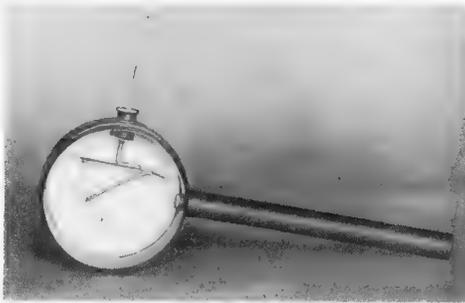
Bild 2. Ein Versuchsmuster des statischen Voltmeters
