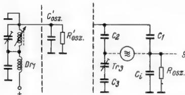
Bild 3. Spannungsteilung an den Kapazitäten C<sub>1</sub> und C<sub>i</sub>
