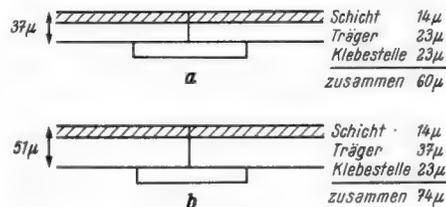
Bild 5a. Mit Langspielband hinterklebtes Langspielband. Die Verdickung ist unwesentlich, die Schmiegsamkeit bleibt erhalten, die Reißfähigkeit ist nicht vermindert
