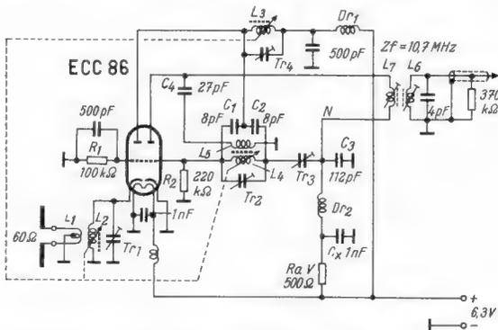
Bild 1. Schaltbild einer UKW-Vor- und Mischstufe mit der Röhre ECC 86
